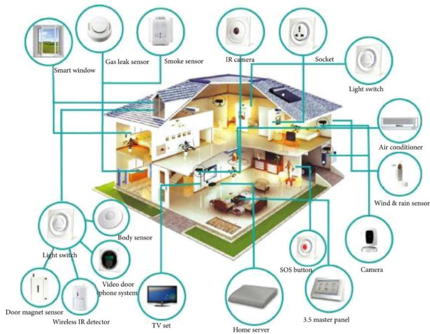
Figura 3. 6: Infraestructura de domótica en una residencia. Fuente: (Yang et al., 2018)
