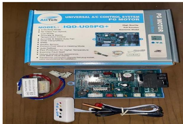
Figura 2.21. Tarjeta electrónica de A/A
