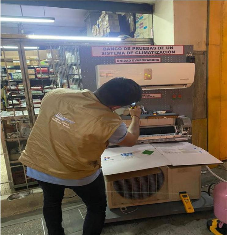
Figura 3.11. Pruebas de medición de temperaturas en el equipo de pruebas
