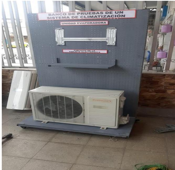
**Figura A.1.1** Ensamble de banco de pruebas
