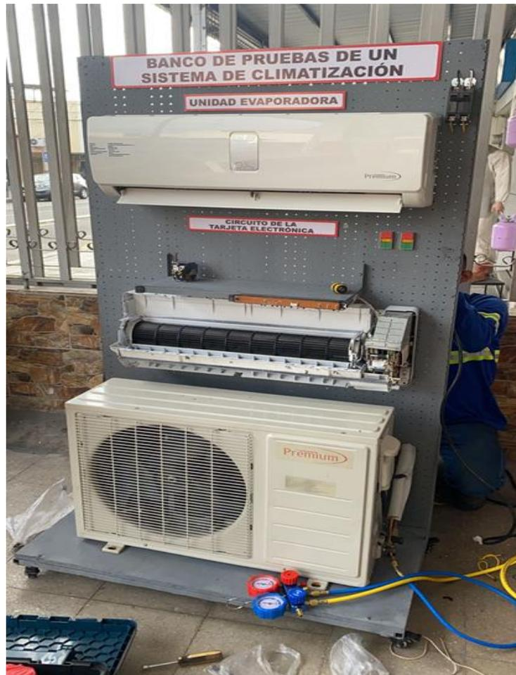
**Figura 3.9.** Ensamble del circuito de la tarjeta electrónica
