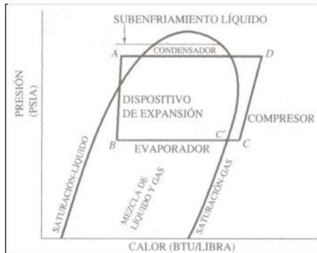
**Figura 2.19.** Principio de refrigeración
