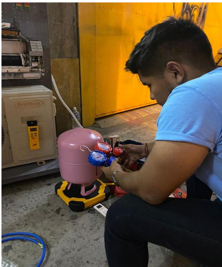
**Figura 3.10.** Recarga de gas refrigerante al equipo de pruebas
