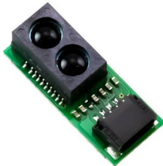
Figura 2.34: Sensor de distancia Fuente: (Hurovich et al., 2015)
