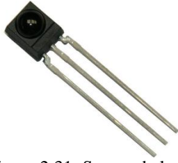
Figura 2.31: Sensor de luz infrarroja Fuente:(Páramo et al., 2014)
