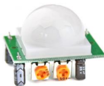
Figura 2.36: Sensor de movimiento Fuente: (Pérez Castro et al., 2010)
