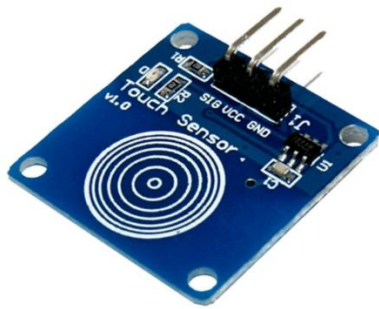
Figura 2.37: Sensor de contacto Fuente: (Paggi et al., 2011)
