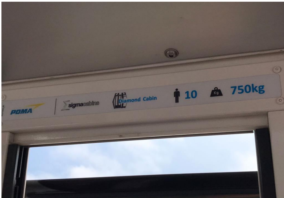
Figura 3. 8 Peso y capacidad máxima admitida en las cabinas de la aerovía (Fuente: Autor)
