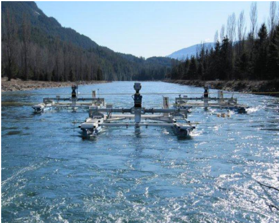
Turbina In-stream en caudal de río pequeño
