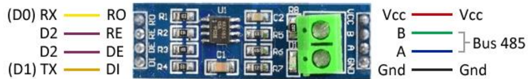
Figura 0-3 Pines del Módulo RS-485 Fuente: (Llamas, 2016)
