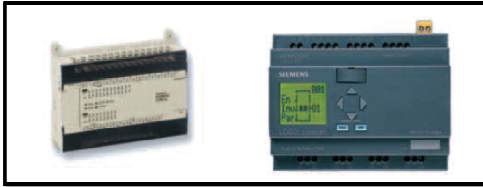
Fig. 3.6 Autómatas Programables y Relé Programable.
