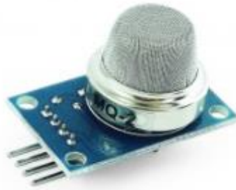
Figura 3. 7: Módulo MQ-2 Fuente: (naylampmechatronics, 2016)
