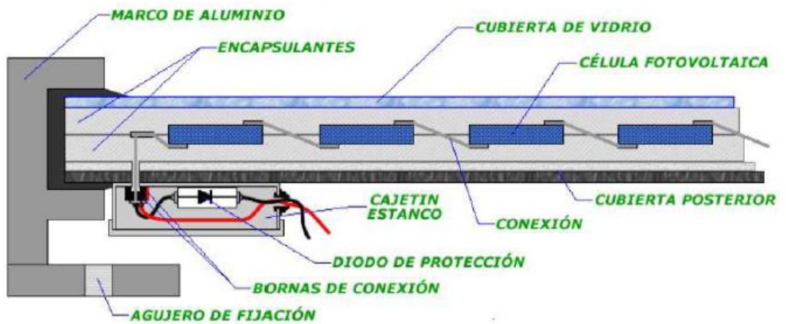
Ilustración 7: Partes de un Panel Fotovoltaico
