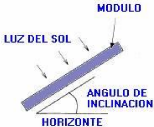
Ilustración 28: Ángulo de inclinación de los paneles solares
