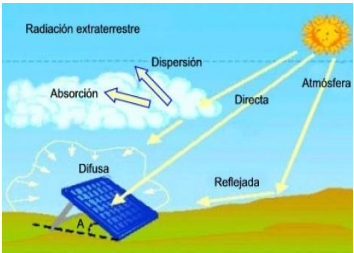
Ilustración 3 Radiación Solar Sobre el panel
