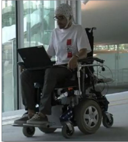
Figura 2.1 Silla de ruedas movida con ondas del cerebro. Fuente: (School of Engineering EPFL -CNBI, 2013)
