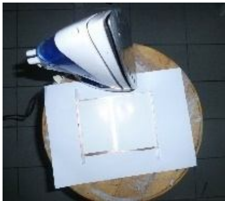
Figura A-2.2 Transferencia del fotolito mediante calor.
