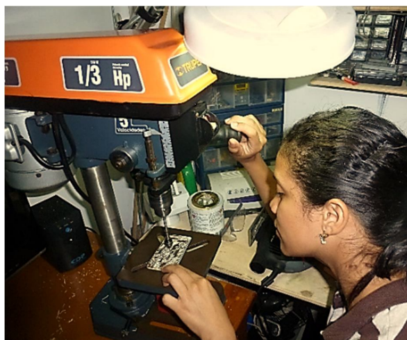
Figura A-6.6 Perforación del PCB.
