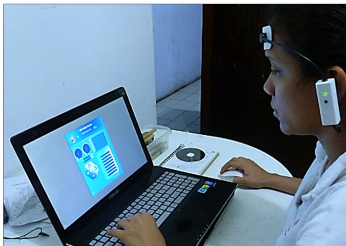
Figura 5.3 Sujeto de prueba en acción con la GUI desarrollada y enlazada a la IBNS. Fuente: Autor S. Álava.
