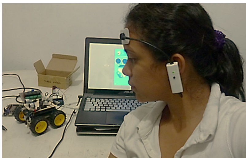
Figura 6.7 Prueba de campo realizada con la IBNS y el Robot en comunicación directa entre el sujeto de prueba y la interfaz de control.
