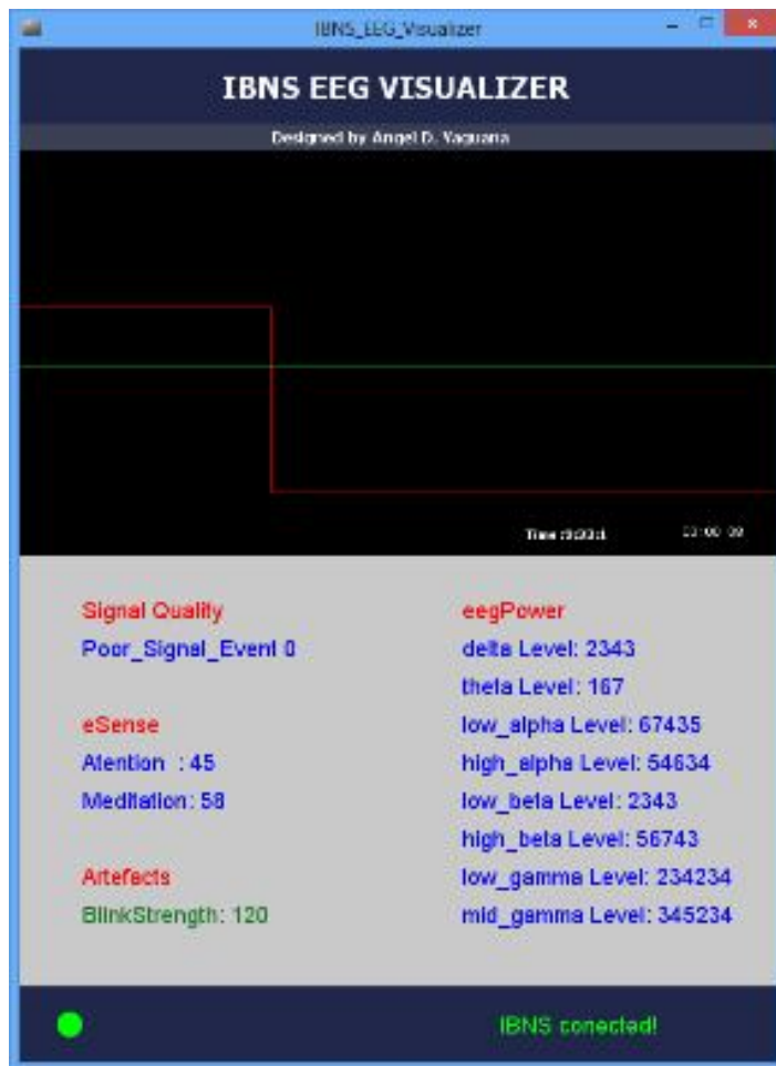
Figura 5.1 Boceto GUI para visualización de datos EEG usando el API proporcionados por NeuroSky. Fuente: (Yaguana, 2014).
