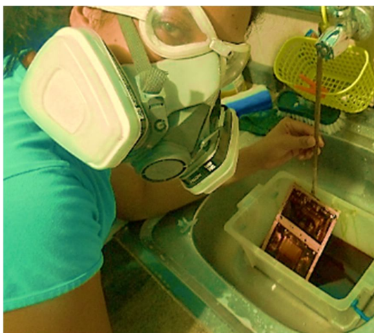
Figura A-6.4 Ataque Químico usando Percloruro de Hierro.
