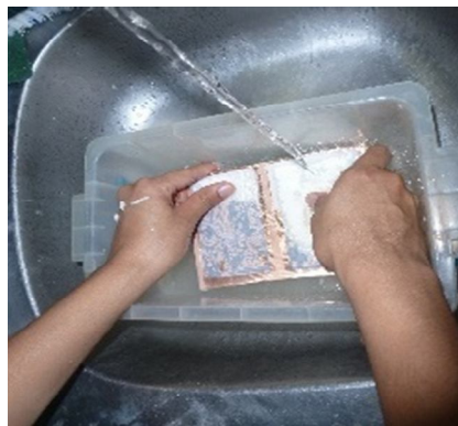
Figura A-6.3 Limpieza de residuos de papel transfer en el PCB previo el ataque químico.
