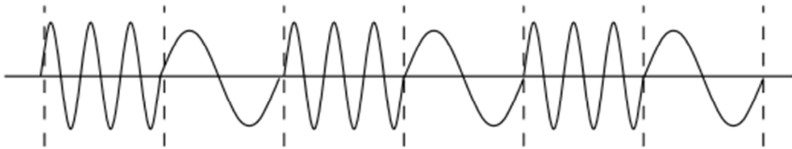
Figura 2. 8: Señal FSK coherente o FSK de Sunde. Fuente: Autor.
