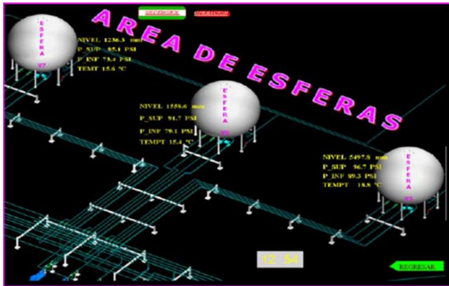
Figura 4.3 Monitoreo de áreas de esferas (SCADA)
