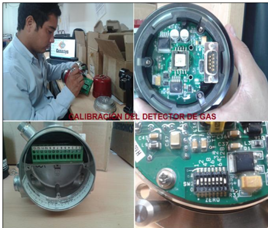
Figura 3.4 Calibración de detectores de gas
