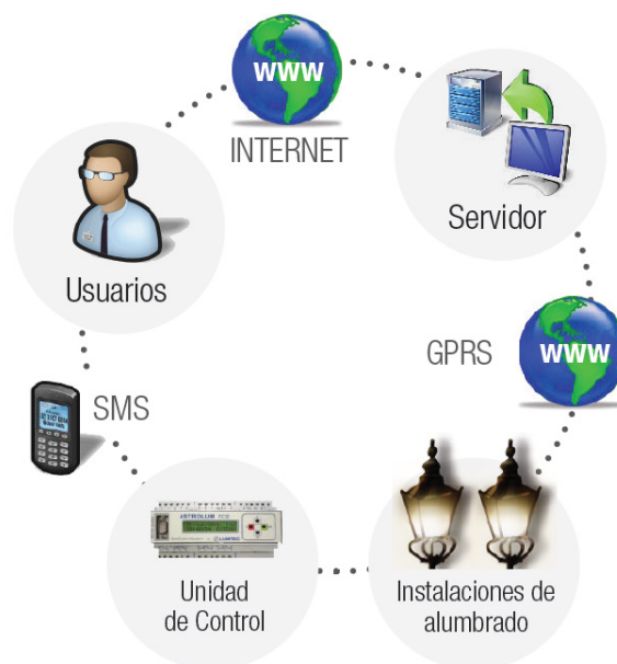
Figura 3.19 Sistema de telegestión Fuente: ( http://www.actiweb.es/instaladorareypena/telegestion.html )
