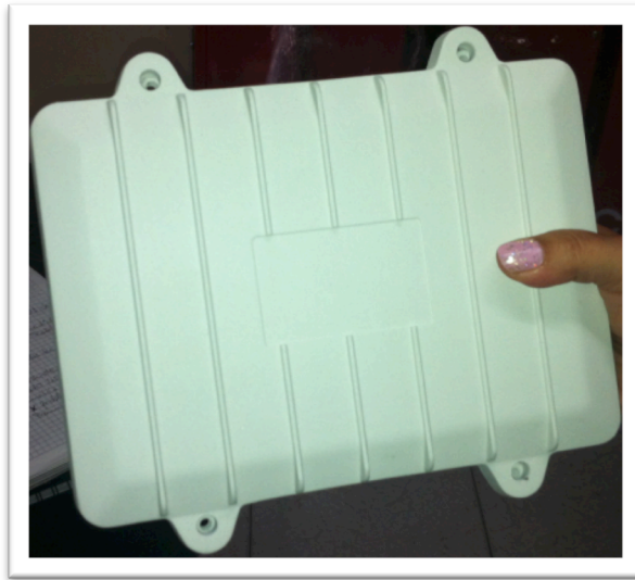
Figura 3.32 Concentrador de las luminarias Fuente: Easymetering
