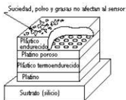
Figura 6.5.2 Diagrama de sustancias que afectan al sensor
