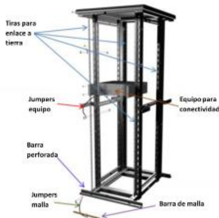
Figura 29 Puesta a tierra Gabinete
