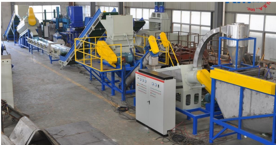
Figura 25. Sistema de lavado y secado de botellas. Tomado de Asian Machinery USA, Inc (2020).
