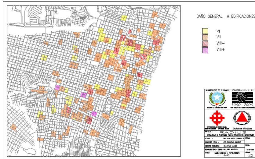
Ilustración 1: Distribución de daños generales sobre las edificaciones
