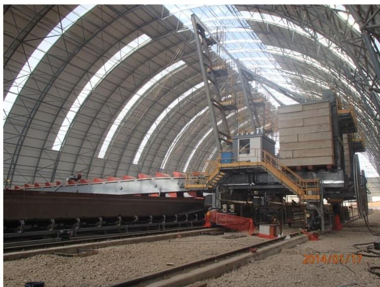
**Figura 3.14 Rascadores de Arcilla (311-RC1 / 311-RC2)**
