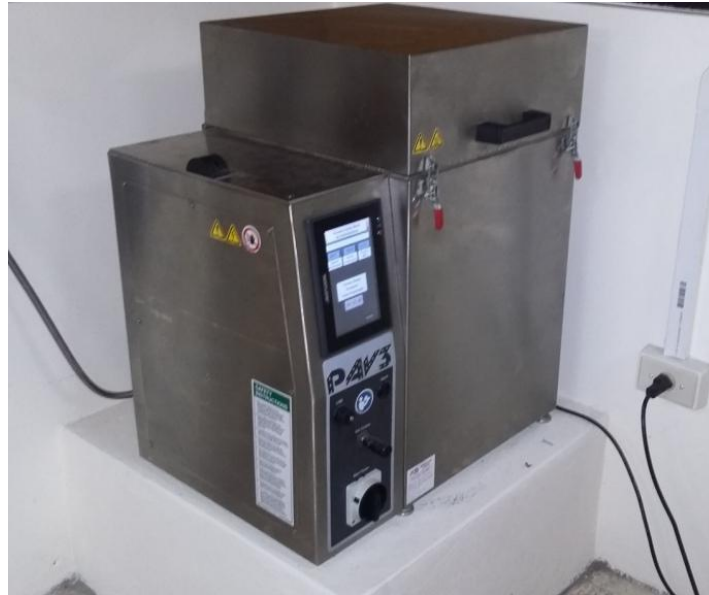
Figura 10. Cámara de envejecimiento a presión. Vila, R. (2020) Material no publicado.
