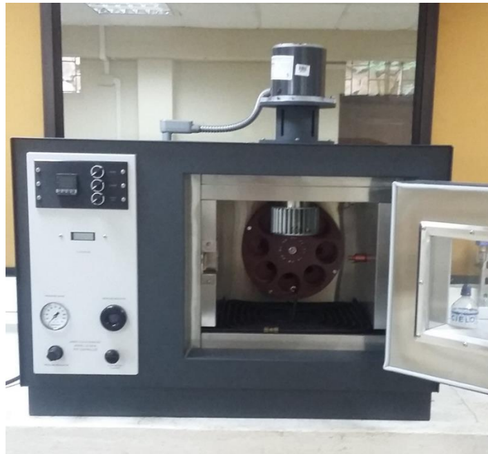
Figura 8. Horno para prueba RTFOT. Vila, R. (2020) Material no publicado.
