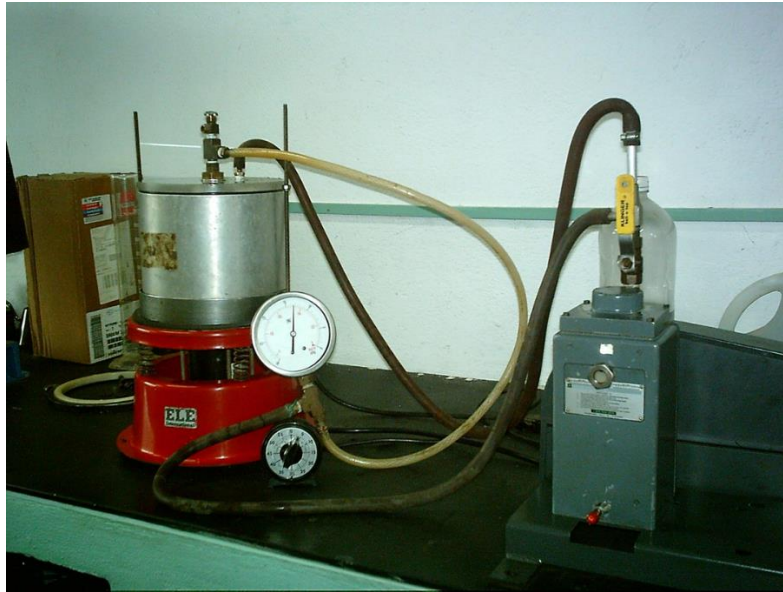
Figura 2. Equipamiento para prueba Rice. Vila, R. (2020) Material no publicado.
