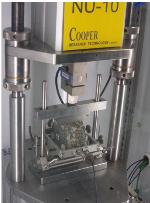
Figura 15. Nottingham Asphalt Mix Tester. Vila, R. (2020) Material no publicado.
