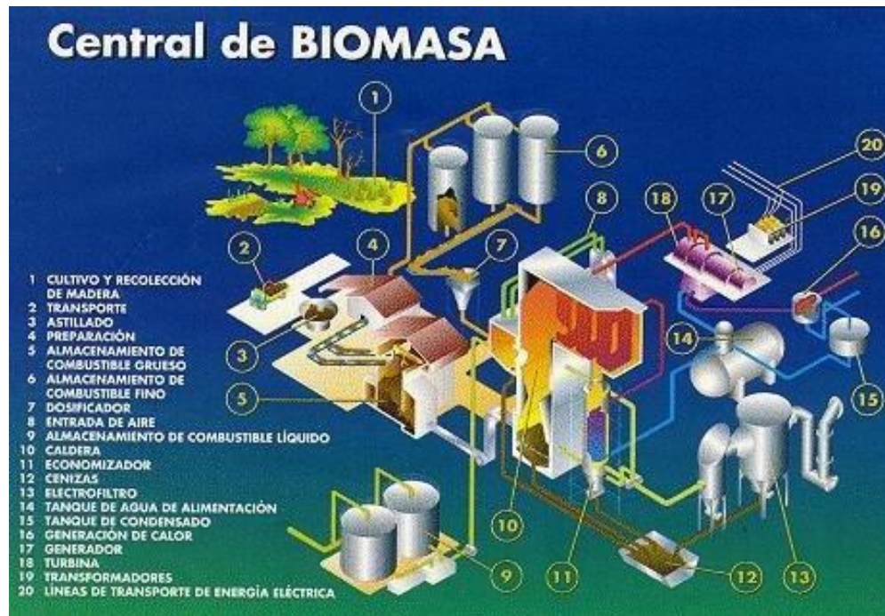
Figura 1.13 Central de Biomasa
