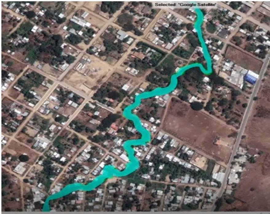
Ilustración 24 Resultado de zonas con riesgo de inundación en el Canal Colibrí
