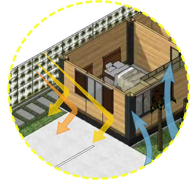
Los paneles de madera que forman el revestimiento del módulo, aísla el paso del calor en un 70% al interior de la vivienda. La conductividad térmica del material es de 0.22W/moC.
