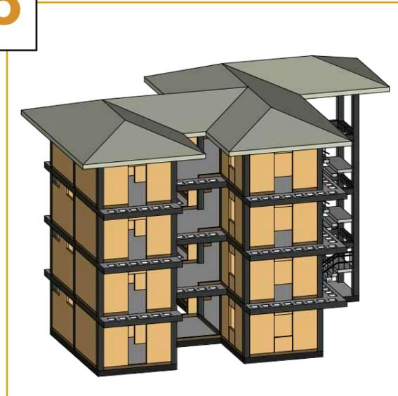
**Paredes:** Se coloca paneles de CLT con medidas 2.44 X 1.22 X 0.10
