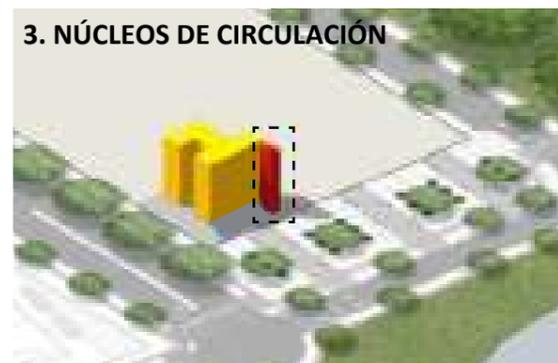
Adición de núcleos de circulación vertical, con el propósito de acceder y conectar entre todos los pisos.
