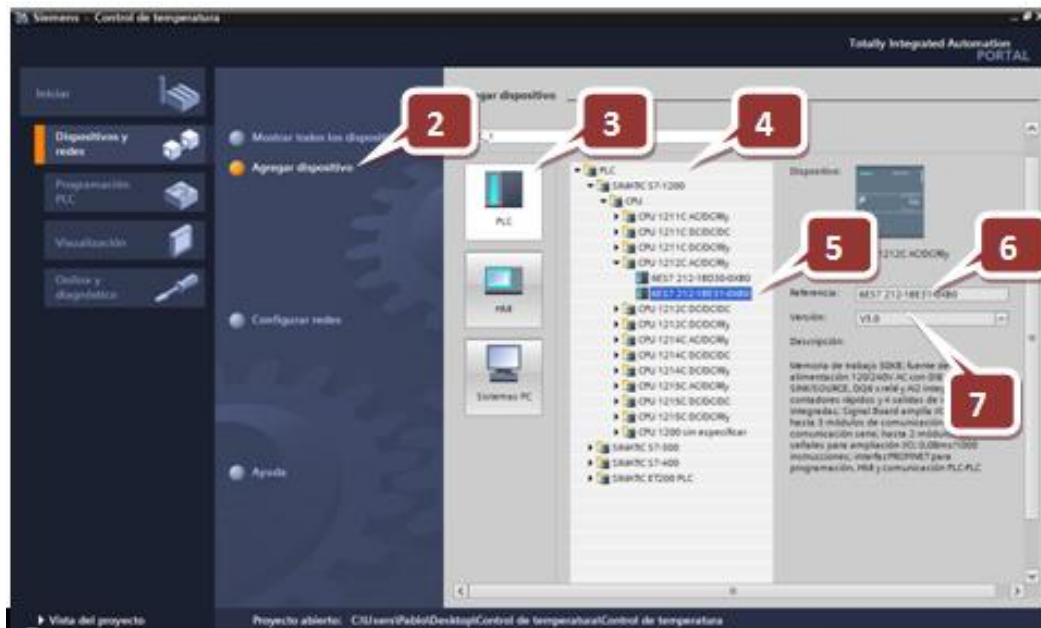
Fig.VI 41 Ventana para agregar PLC.
