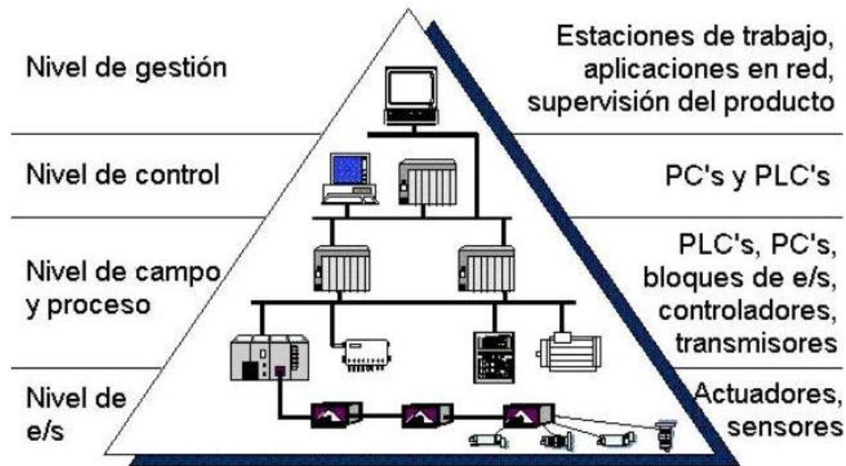
FIG IV 21 Nivele de Capas en una Red Industrial.
