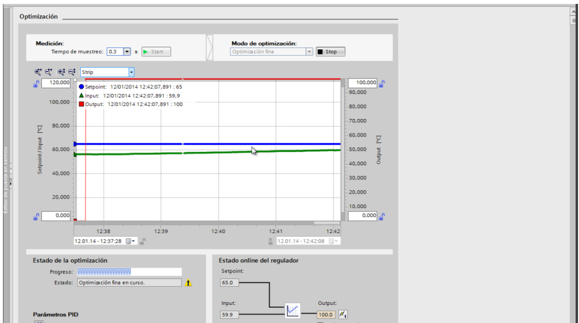
Fig. VI 77 Ventana de Ajuste y Optimización del Bloque PID (Optimizando a 65°C)
