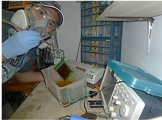
Figura 10 A-6 Ataque Químico usando Percloruro de Hierro y Peróxido de Hidrogeno.
