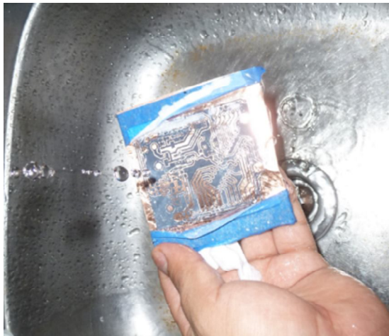
Figura 10 A-4 Limpieza de residuos en el PCB para garantizar un buen ataque químico.
