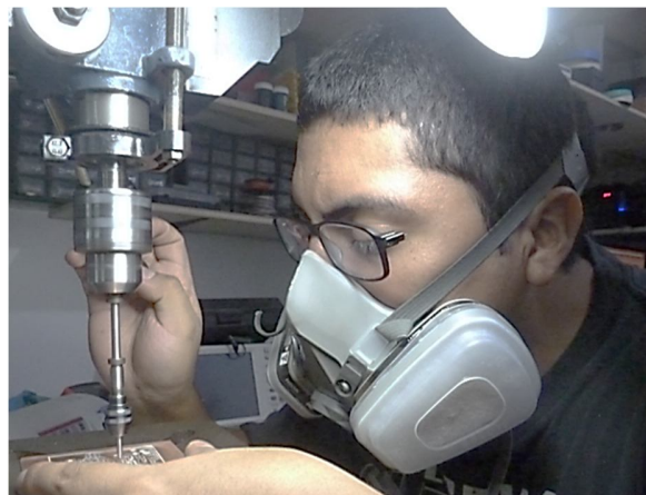
Figura 10 A-8 Perforación del PCB.
