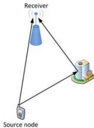
Figura 2. 2: Canal convencional de radiofrecuencia multitrayecto. Fuente: (Ketterl et al., 2012)
