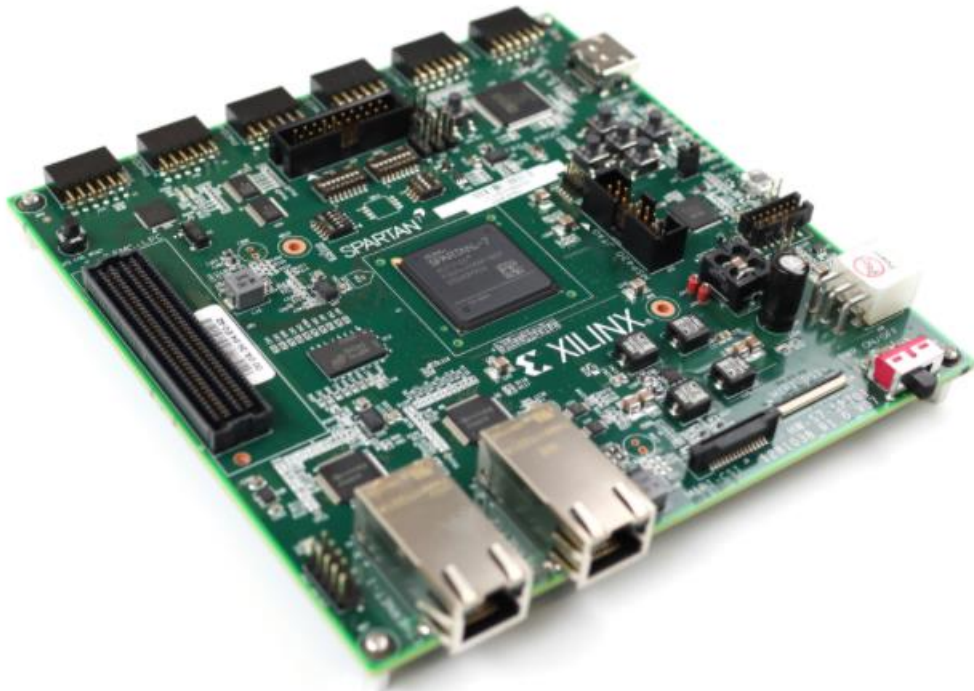
Figura 2. 5: Tarjeta FPGA utilizada como una SDR. Fuente: (Xilinx, 2021)
