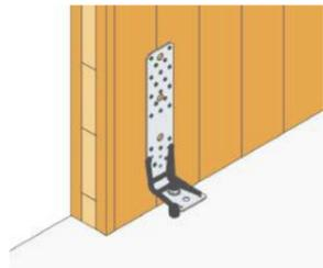
Fijación de Anclaje AKR95X3L.
