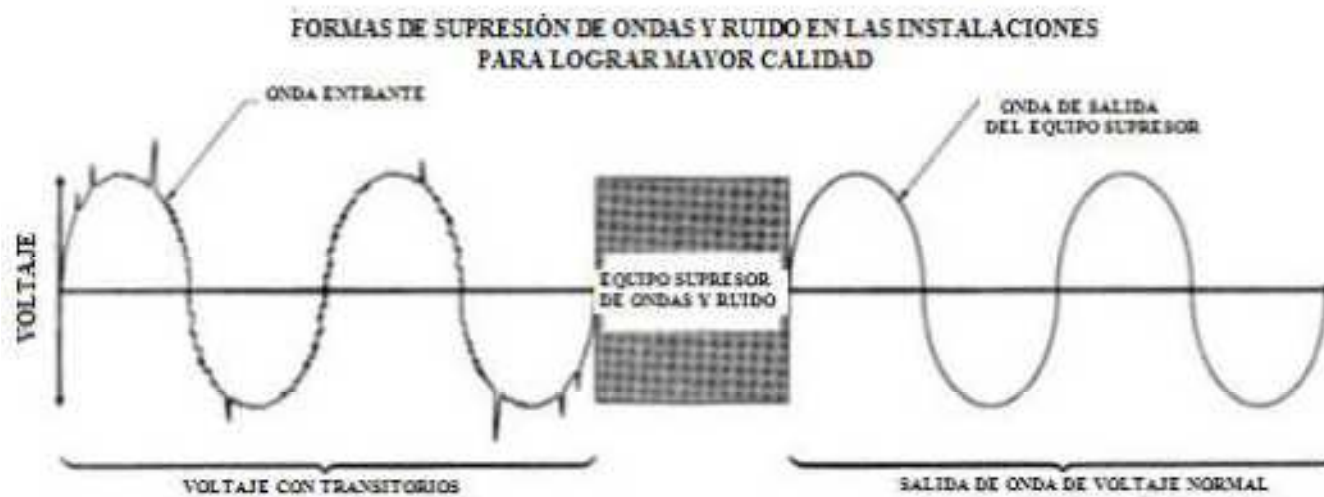
Figura 3.16.- Aplicación del equipo supresor de ondas y ruido Fuente: El ABC de la calidad de la energía eléctrica
