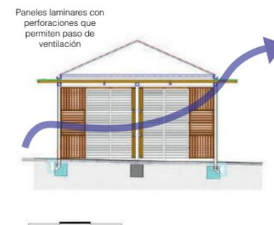
Los módulos presentan paredes y cubierta de madera con perforaciones que permite el paso de la luz y el viento permitiendo de esta forma el ingreso de la ventilación cruzada e iluminación natural.
