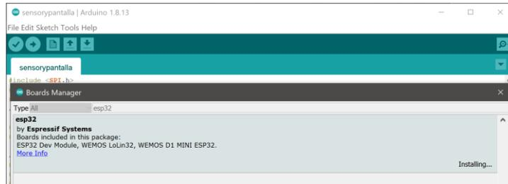
Figura 3. 3: Instalador Esp32
