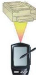
Figura 2. 4: Comunicación IrDA entre PDA e impresora (punto a punto)
