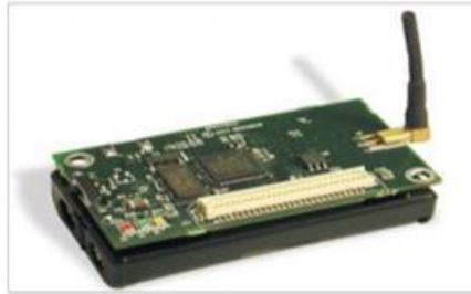
Figura 2. 12: Mote MicaZ: tamaño (mm): 58x32x7, peso (gramos):18 (Sin baterías).
