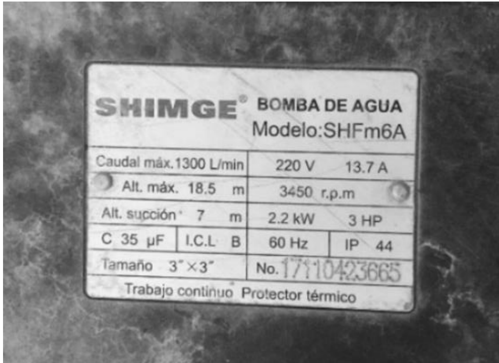
Figura 3.6. Bomba de caudal de 3 HP.
