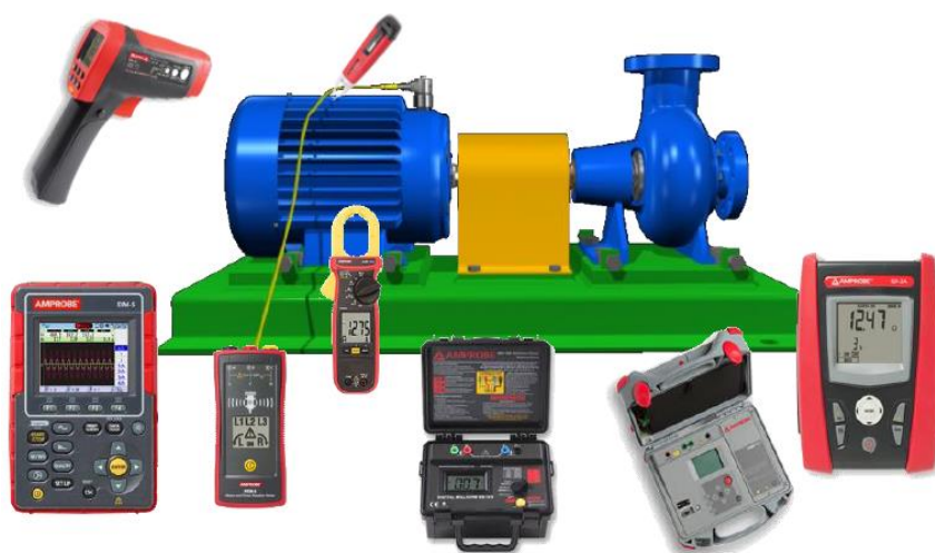
Figura 2. 8 Equipos de mediciones para las fallas de motores trifásicos por mala calidad de energía eléctrica.
