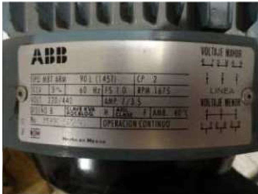
Figura 4.1: Ejemplo de una placa de características de un motor
