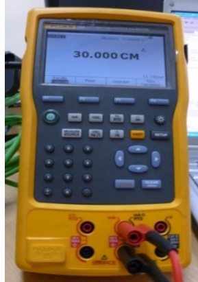
Figura # 4. 51: Medición de nivel de 30cm con el fluke 756 Fuente: Héctor Galvis y Humberto Zeas
