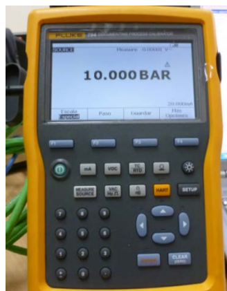
Figura # 4. 44: Medición de la presión de 10 BAR con el fluke 756 Fuente: Héctor Galvis y Humberto Zeas
