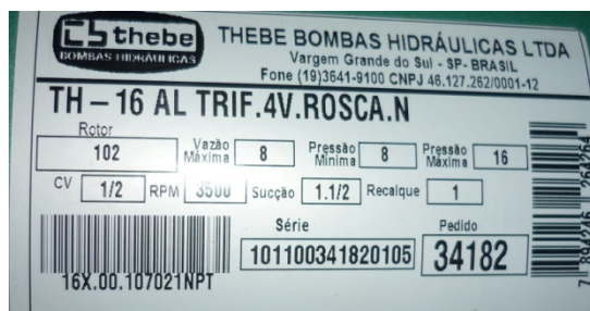
Figura # 3. 17: Datos de placa de la bomba centrífuga THEBE
