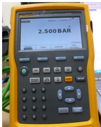
Figura # 4. 38: Medición de la presión de 2.5 BAR con el fluke 756 Fuente: Héctor Galvis y Humberto Zeas
