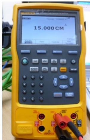
Figura # 4. 48: Medición de nivel de 15cm con el fluke 756 Fuente: Héctor Galvis y Humberto Zeas
