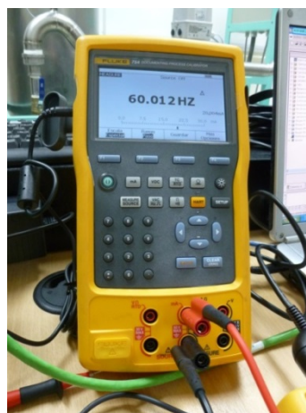
Figura # 4. 25: Medición de la señal de corriente con el fluke 756 Fuente: Héctor Galvis y Humberto Zeas
