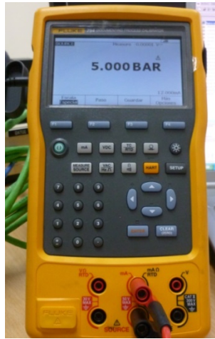
Figura # 4. 41: Medición de la presión de 5 BAR con el fluke 756 Fuente: Héctor Galvis y Humberto Zeas
