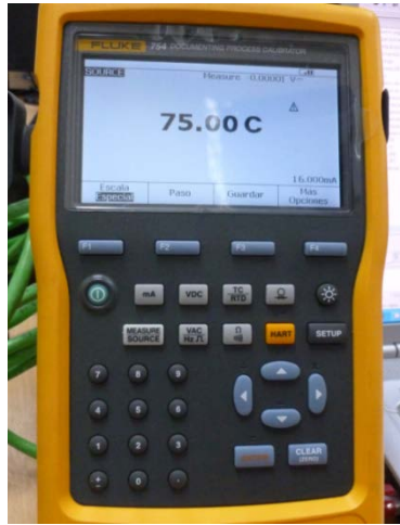
Figura # 4. 34: Lectura de la temperatura de 75c con el fluke 756 Fuente: Héctor Galvis y Humberto Zeas
