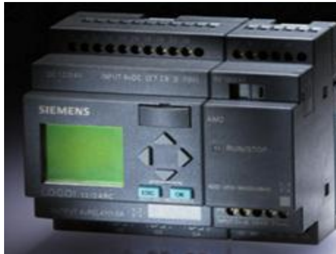
Figura 4. 2 LOGO! Siemens 12/24 RC con módulo de expansión Fuente: Tablero didáctico
