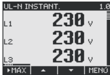
Figura # 4.4: Visualización de la tensión medida para el tipo de conexión 3P4W
