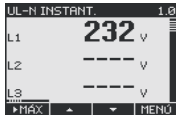
Figura # 4.5: Visualización de la tensión medida con el tipo de conexión 1P2W
