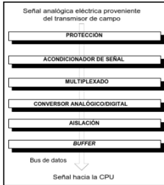
Figura # 2.36: Etapas que conforman una interfaz de entrada analógica.
