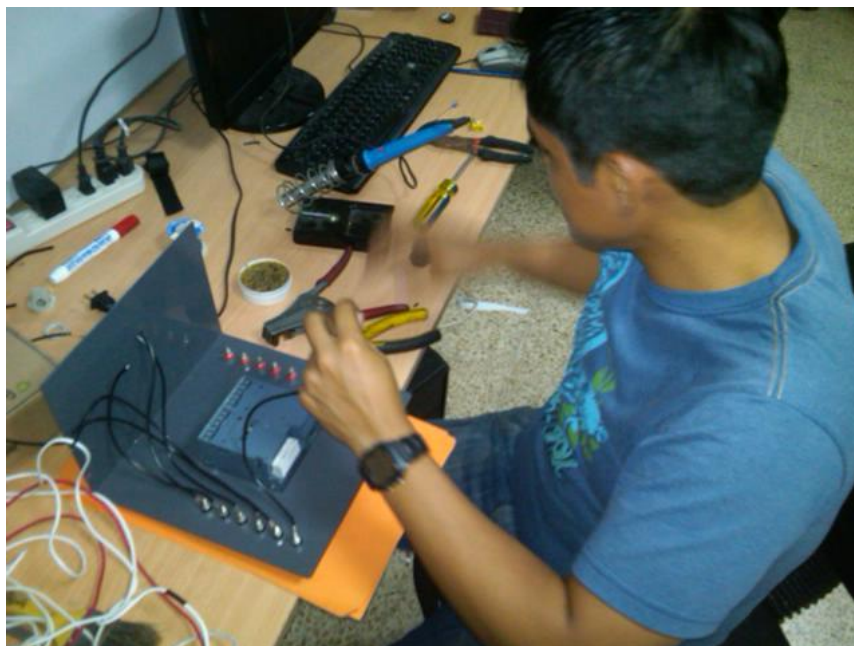
Figura 40: Cableado de entradas I/O del equipo SENTRON PAC 3200.
