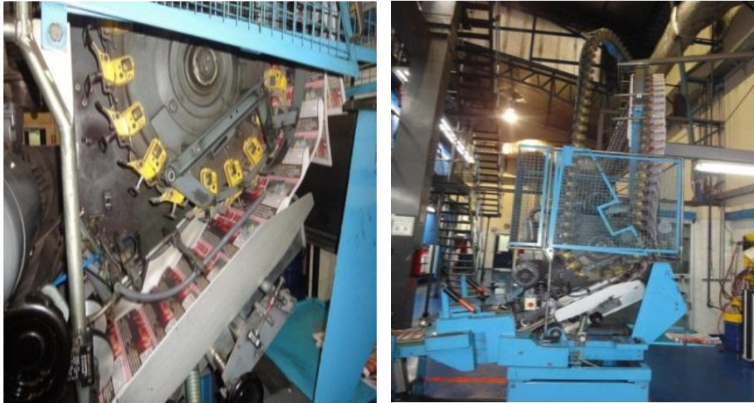
Figura 9: Las pinzas toman los ejemplares impresos individualmente.
