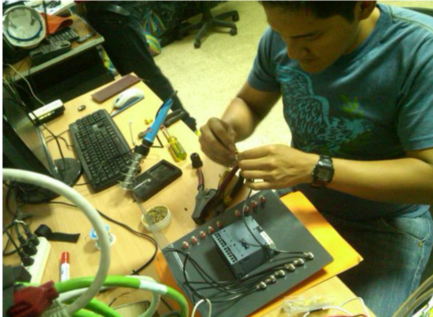
Figura 39: Realizando conexión de materiales al SENTRON PAC 3200.
