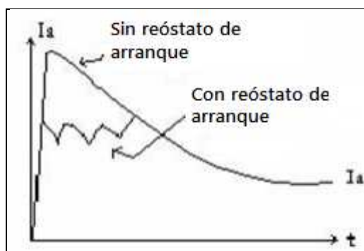
Figura 1.7 La corriente con y sin reóstato
