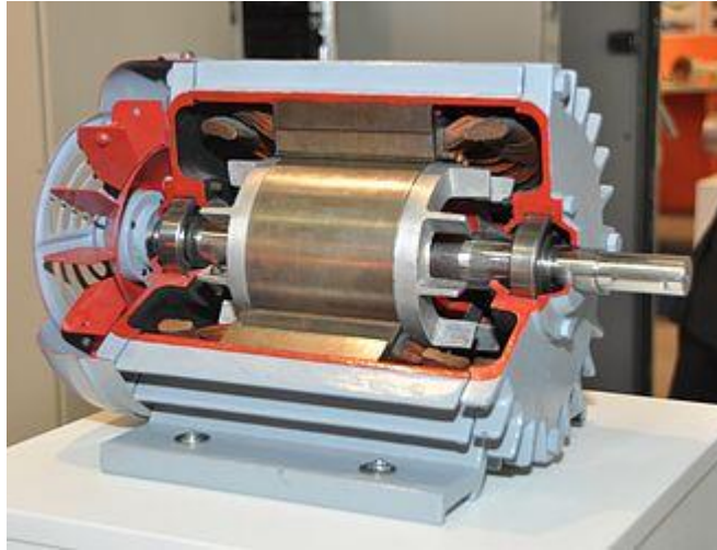
Figura 27. Rotor, estator y ventilador de un motor eléctrico Fuente: http://es.wikipedia.org/wiki/Motor_el%C3%A9ctrico
