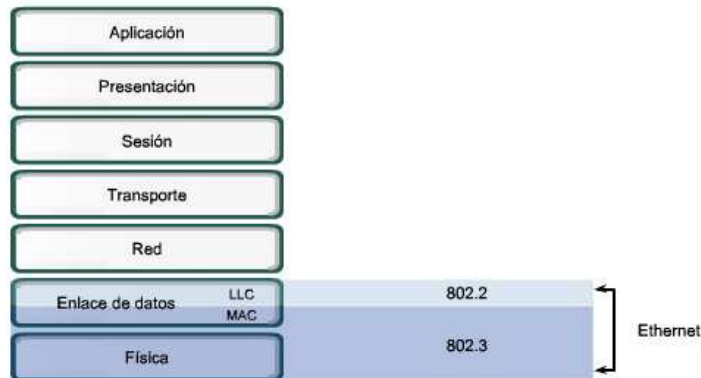
Figura # 2. 3: Capas en que opera Ethernet.
