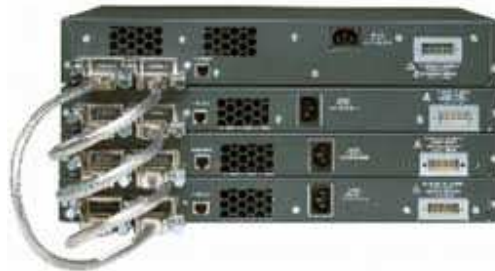
Figura # 4. 2: Apilamiento de más de dos unidades de switches , no se pierde rendimiento de funcionamiento.
