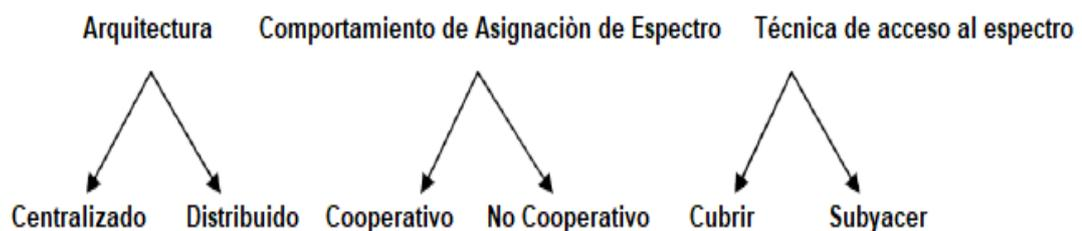
Figura 2. 10: Clasificación del espectro compartido en radio cognitiva.
