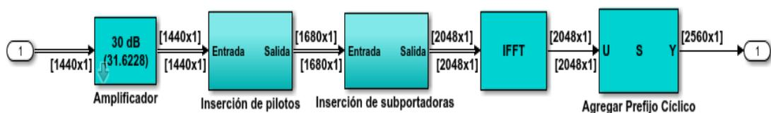
Figura 3. 9: Módulos del subsistema 2 para el transmisor QPSK.
