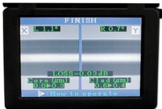
Figura 2.11. Parámetros técnicos de un empalme realizado a dos hilos de fibra óptica. Fuente: Fabricantes y modificada por el Autor
