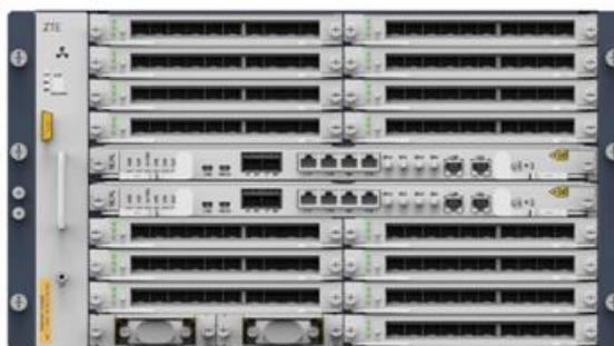
Figura 4.5. Equipo ZXMP-M721-CX66A desarrollada por la empresa ZTE. Fuente: (ZTE, 2020).
