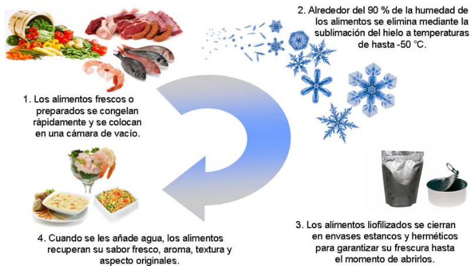
Figura 36. Explicación sobre el proceso de liofilización.
