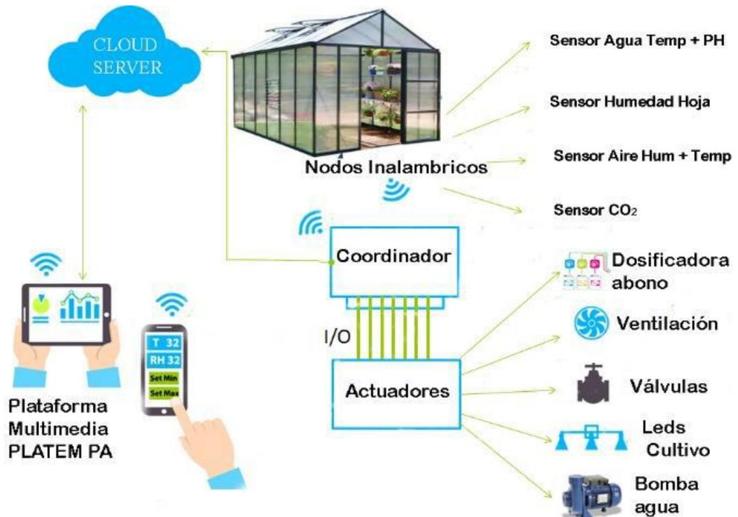
Figura 2. 9: Aplicación de una WSN mediante sensores direccionales pasivos.
