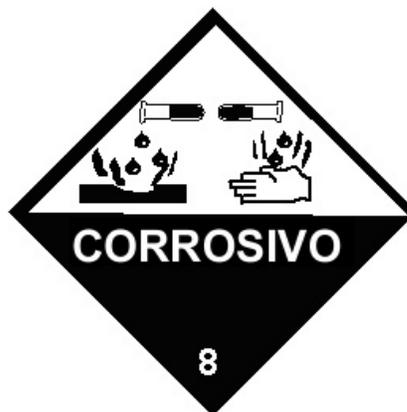
Figura 3: Etiqueta icónica de corrosivo.
