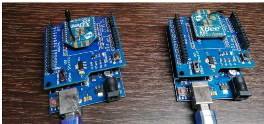
Figura 3.9 Conectorización de los módulos Xbee Foto: Autor
