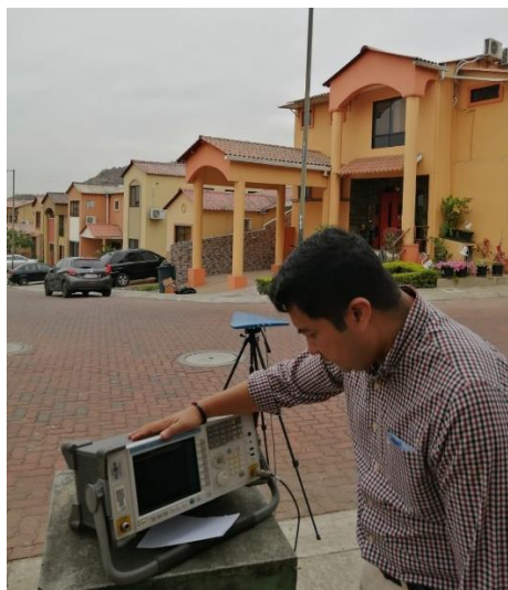
Figura 3.48 Escaneo de frecuencias WIFI en campo abierto. Fuente: Autor
