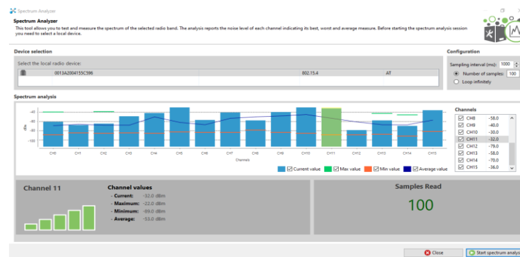
Figura 3.32 Analizador de espectros de WIFI con XCTU.
