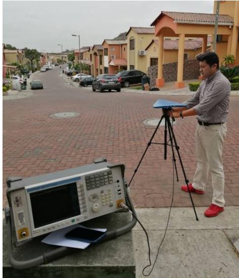
Figura 3.49 Alineación de antena para el scaneo de frecuencias. Fuente: Autor
