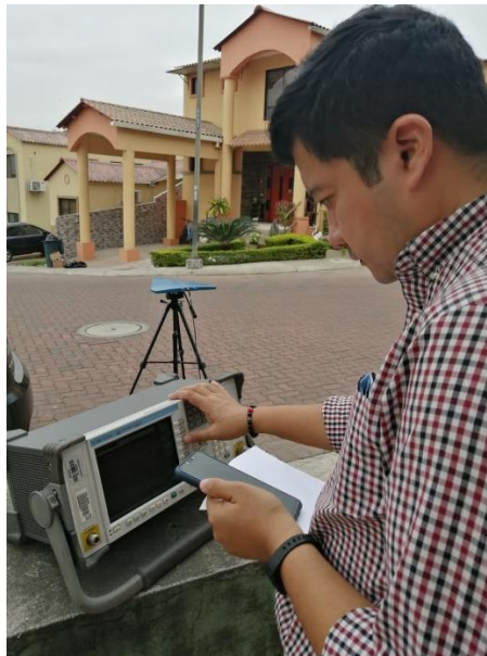
Figura 3.50 Configuración de analizador de espectros Fuente: Autor
