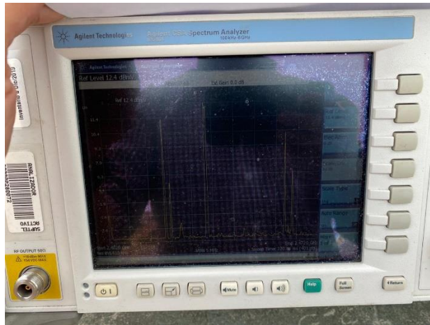
Figura 3.52 Escaneo de frecuencias de WIFI 2,4 Ghz en campo abierto segunda toma Fuente: Autor
