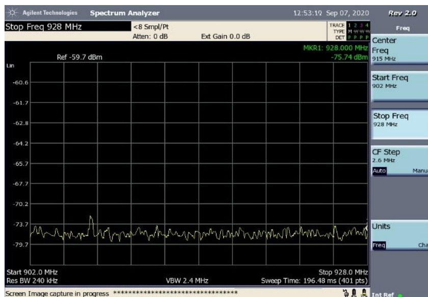
Figura 3.59 Escaneo de frecuencias LoRaWAN segunda toma (902 Mhz – 928 Mhz) Fuente: Autor
