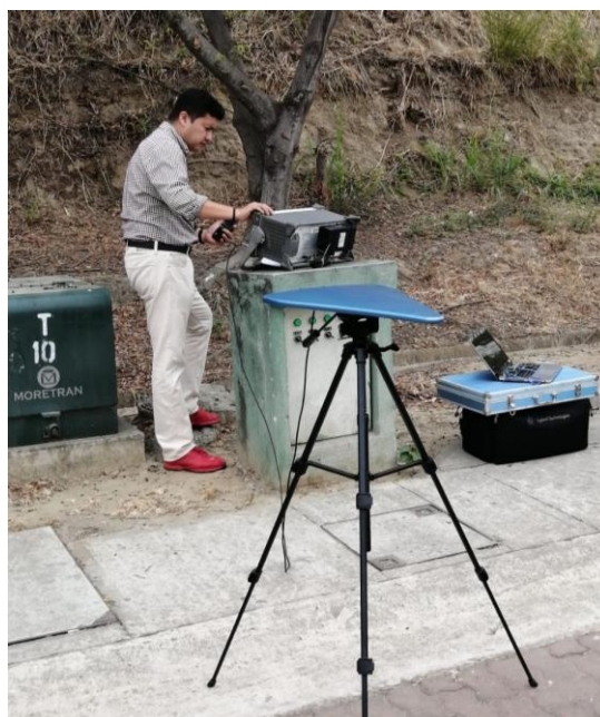
Figura 3.45 Montaje del módulo de pruebas con Analizador de espectros y antena Fuente: Autor
