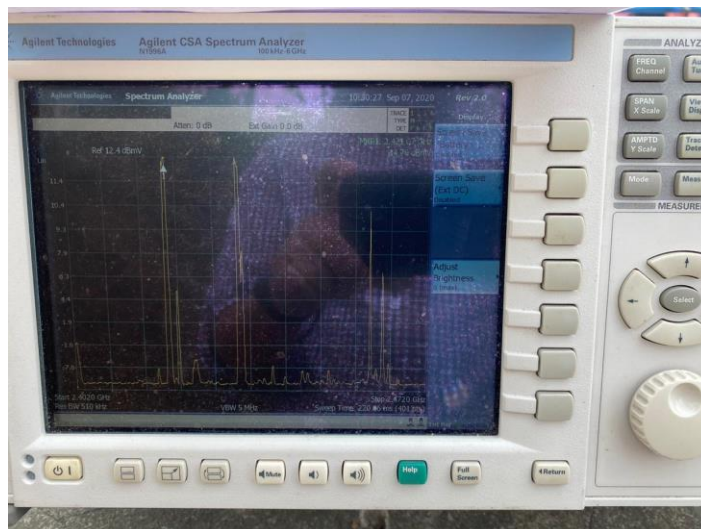
Figura 3.53 Escaneo de frecuencias de WIFI 2,4 Ghz en campo abierto tercera toma Fuente: Autor
