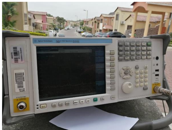
Figura 3.58 Escaneo de frecuencias LoRaWAN (902 Mhz – 928 Mhz) Fuente: Autor
