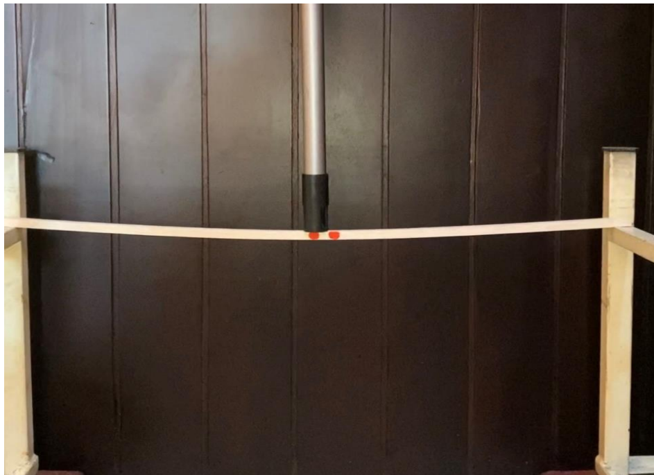
Ilustración 5 Elemento simplemente apoyado con una carga Puntual en el centro del claro. Obtenida de: Melissa Rojas Yela
