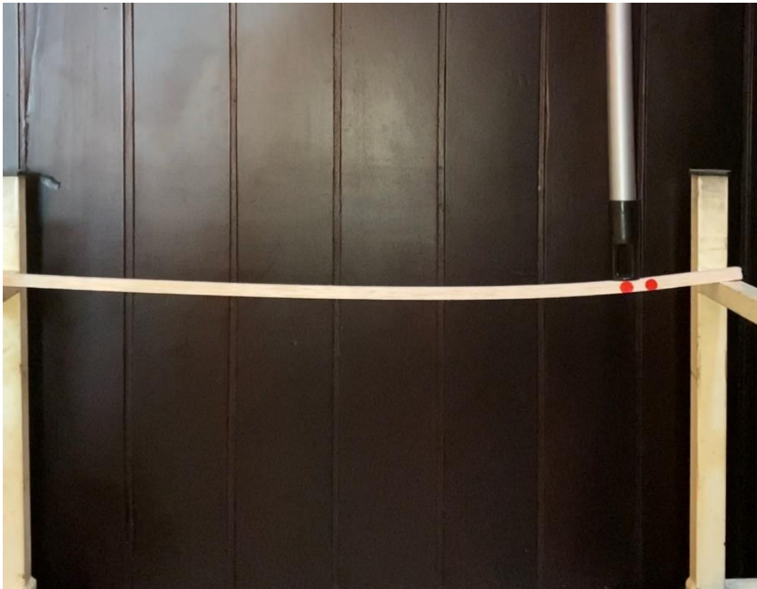
Ilustración 8 Elemento simplemente apoyado con una carga Puntual en uno de los extremos. Obtenido de: Melissa Rojas Yela
