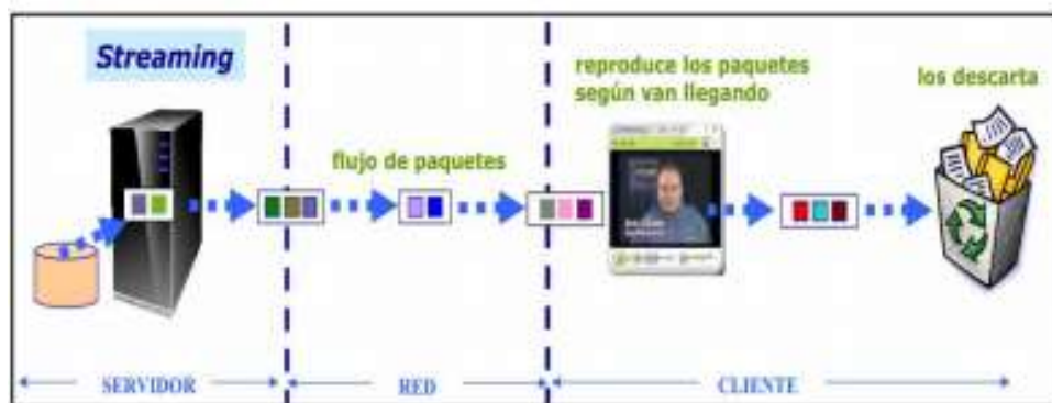
Figura 2. Esquema de funcionamiento del servicio streaming (video a demanda) Barria y Hales (2013)
