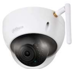
Cámara con puerto Wifi tipo Domo IPC-HDBW1235E-W
