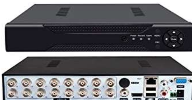
Figura 2.9 (b): Ejemplo de DVR. Fuente: www.abowone.com
