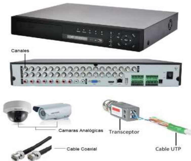
Figura 2.10: DVR Analógico y elementos de conexión. Fuente: Elaborada por el Autor con imágenes de los fabricantes.
