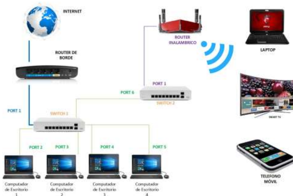
Figura 2.7 (b): Diseño de una red utilizando un Switch. Fuente: Elaborada por el Autor.
