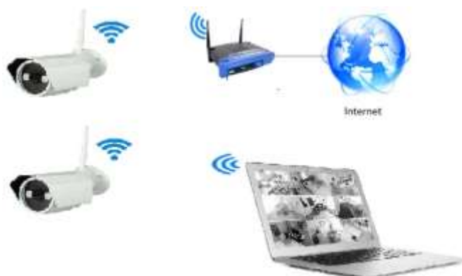
Figura 2.21: Ejemplo de medio de transmisión no guiado. Fuente: Elaborada por el Autor.
