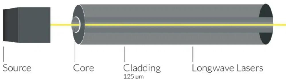
Figura 2. 3: Principio de propagación de la luz en una fibra monomodo.
