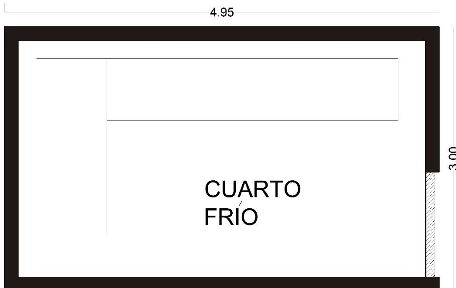
Gráfico 28. Detalle Cámara de frío
